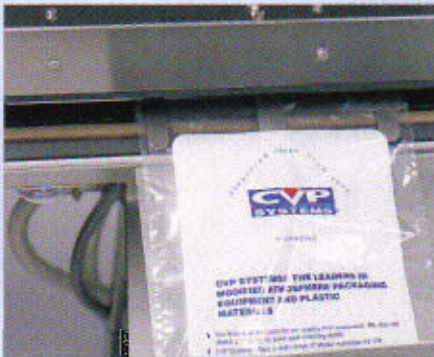
Tensadores de bolsa minimizan dobleces para un sellado integro y estético.
